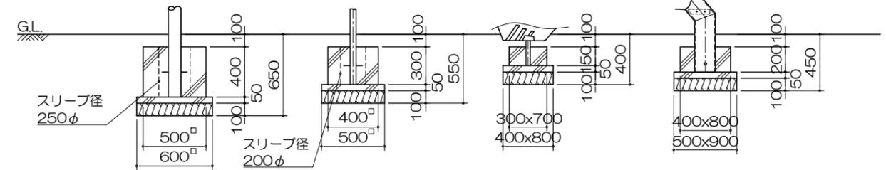
E型基礎x1ヶ 金ゴテ仕上げ 面とり F型基礎x2ヶ 11.着地マット 接着止め
