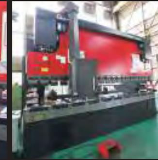
高速・高精度ハイブリッド・ドライブシステムを採用。上下2カ所の金型で金属の板（鉄板）を折り曲げるマシンです。幅約3,100mmまで、板厚0.8mm～25mmまで対応しています。
