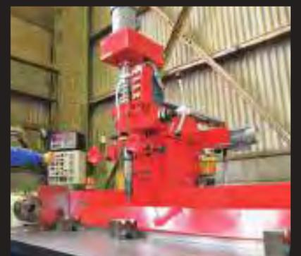
スピーディーで高精度の位置決めができるNC装置付きドリル加工機です。主にロックピン用の穴を並行にあけるなどに活用。大型工作機械に匹敵する大きな移動距離（約3,000mm）が特徴です。
