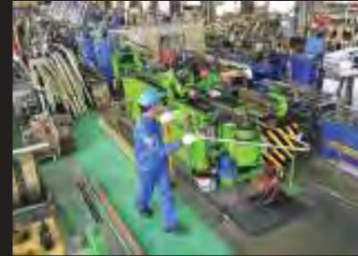
連続的に変化するような形状も自由自在に曲げられる加工機です。また断面の変形が少なく綺麗な仕上がり特徴の最新型NC装置付きベンダーです。
