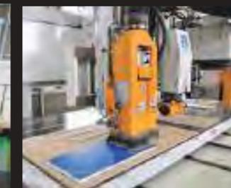
樹脂板を好きな形状で彫り込むことが可能なコンピュータ制御のNCルーター加工機を導入しており、あらゆる製品の精密な加工を可能としています。
