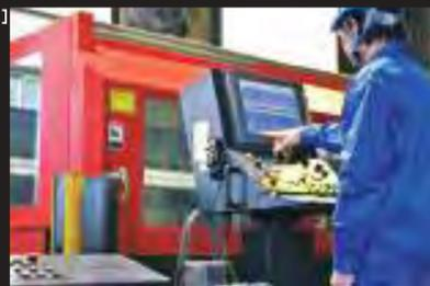
スチール、ステンレス等の金属をレーザー光の力を利用して複雑な形に切断でき、精密な物から大きな物まで、あらゆる加工ができる高速で優れた操作性と作業性を実現したレーザー加工機を導入。パイプ・形鋼の高速かつ高精度加工を可能とするロータリーインデックス装置、FO-MIINT機能を搭載した最新機です。
