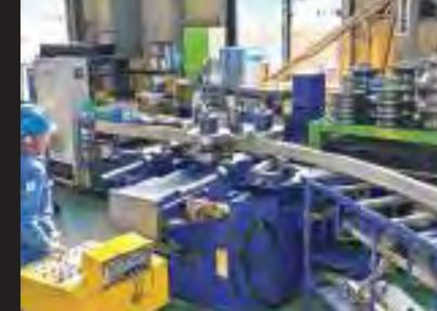
丸パイプ、角パイプ、H鋼を曲げられる加工機です。60.5φから139.8φのサイズまで対応。その他17.3φから加工可能な縦型ベンダーも導入しています。
