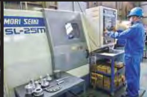
コンピュータ制御によるNC旋盤加工機は複数か所の加工を同時に行うことができ、高精度が求められる特殊部品の自社製作を可能としています。
