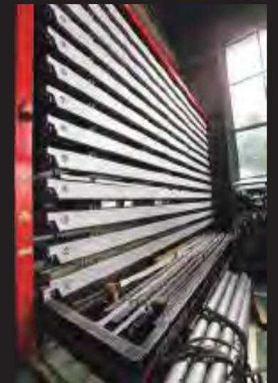
サイズごとの鋼材・パイプ類、積み重ねできない材料などを収納。目的の材料を自動的に呼び出せるため安全で作業効率もアップ、スペースの有効活用、コストダウンにも貢献しています。
