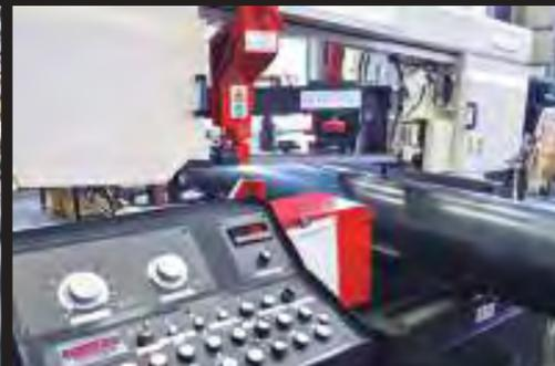
通称バンドソーブレードは、鋼材の切断を行う加工機です。材料の長さを自動で切断できる送材機能を持ち、420角、450φまで対応しています。
